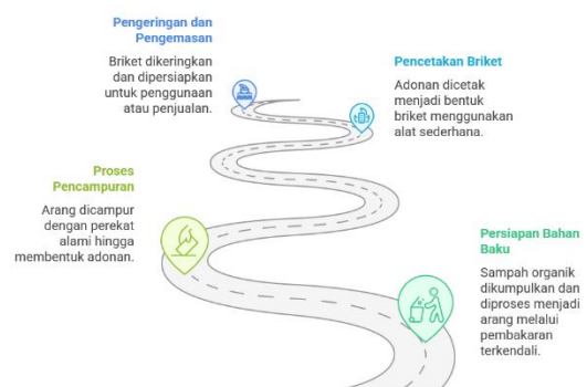
Gambar 2. Alur Proses Pembuatan Briket Berbahan Sampah Organik
